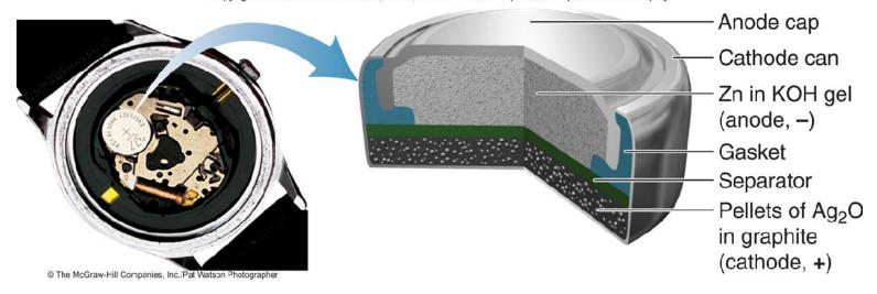
Anode (oxidation):  $Zn(s) + 2OH^{-}(aq) \rightarrow ZnO(s) + H_2O(l) + 2e^{-l}$
